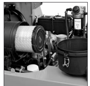
Werkzeugloser Zugang zum Zyklon-Luftfilter
